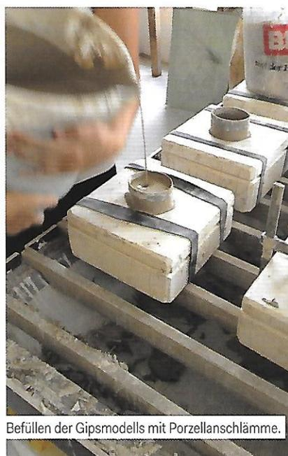
Befüllen der Gipsmodells mit Porzellanschlämme.
