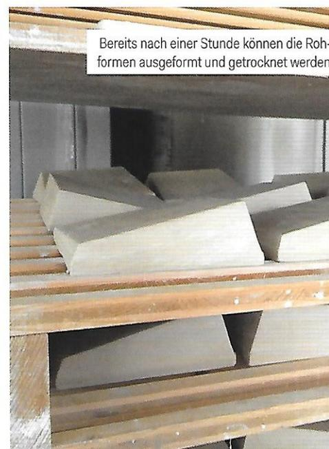
Bereits nach einer Stunde können die Rohformen ausgeformt und getrocknet werden.
